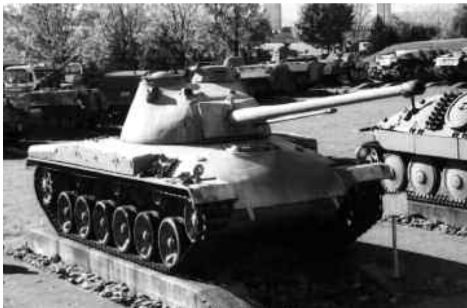
Char 61, avec canon de 8,4 cm et canon coaxial de 20 mm.
