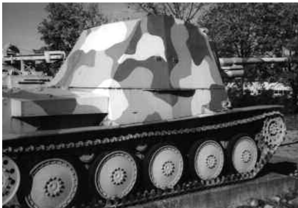
Nahkampfkanone I , sur châssis de Praga , avec un canon de 7,5 cm.
