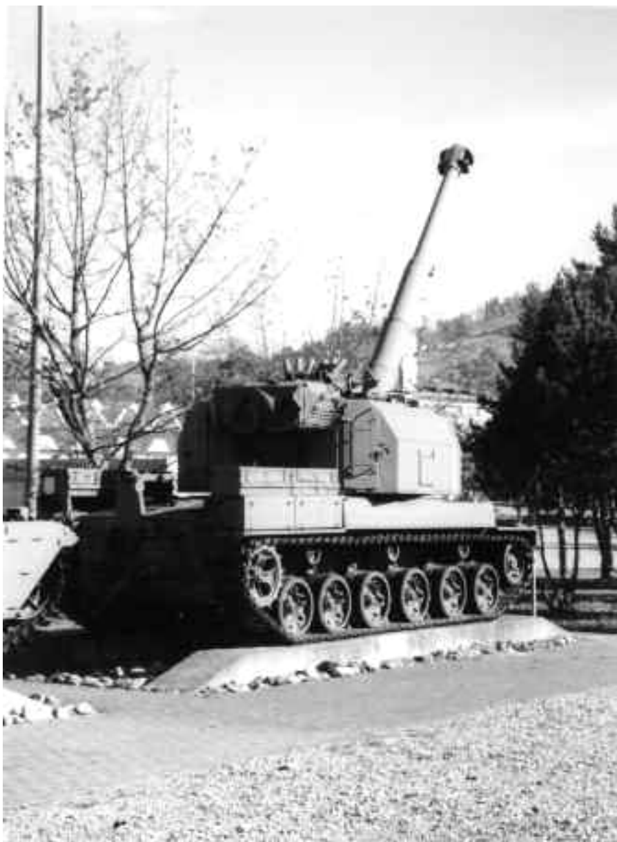
Prototype d'obusier blindé sur un châssis de Char 68 .
