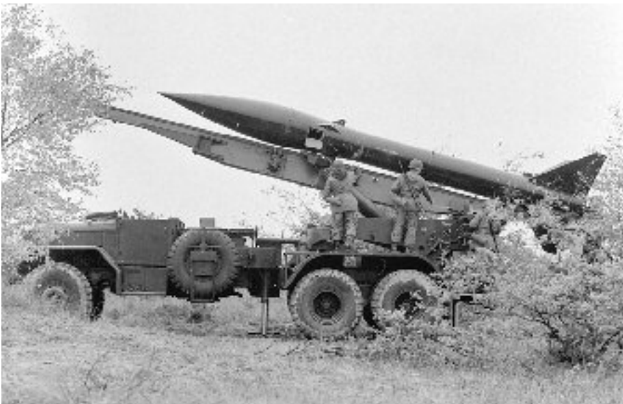
Abb. 20: Feldrakete MGR-1 Honest John auf Lkw 5to (6x6) glw. Die Rakete hatte eine Reichweite von bis zu 48 km und konnte mit einem nuklearen Gefechtskopf mit bis zu 40KT ausgestattet werden (© Bundeswehr/Siwik).
